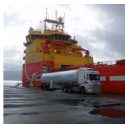
Truck-to-ship LNG bunker
